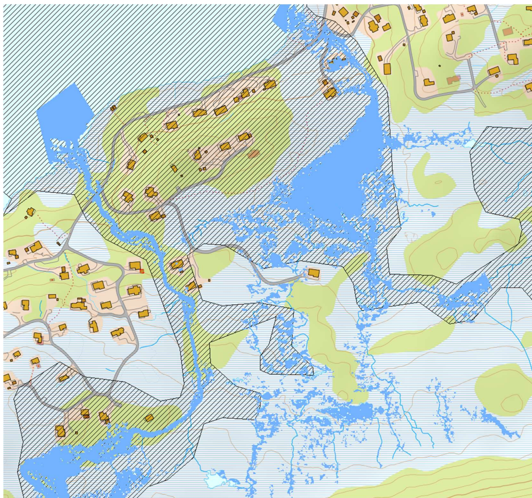
Figur 10 Simulert 200-årsflomsone (+ 40% klimapåslag) for Raudegrovbekken og Stigelibekken i blått sammen med skravert aktsomhetssone for flom fra NVE Atlas i svart.
